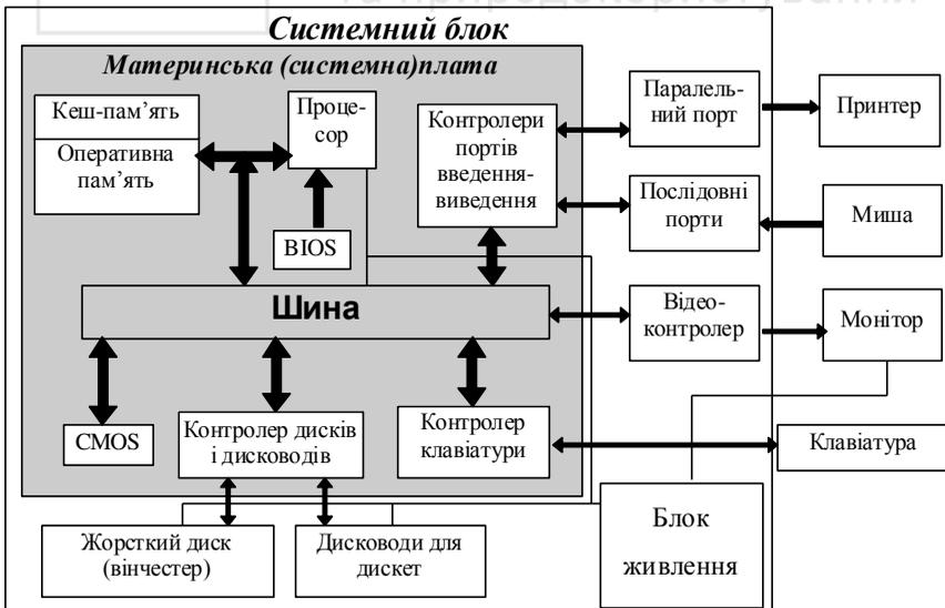
Рис.1.7. Блок-схема пристроїв персонального комп'ютера
